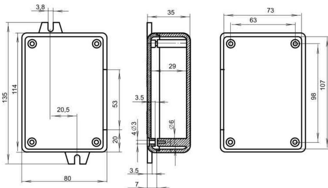
Рисунок А.2 – Габаритные и установочные размеры прибора
