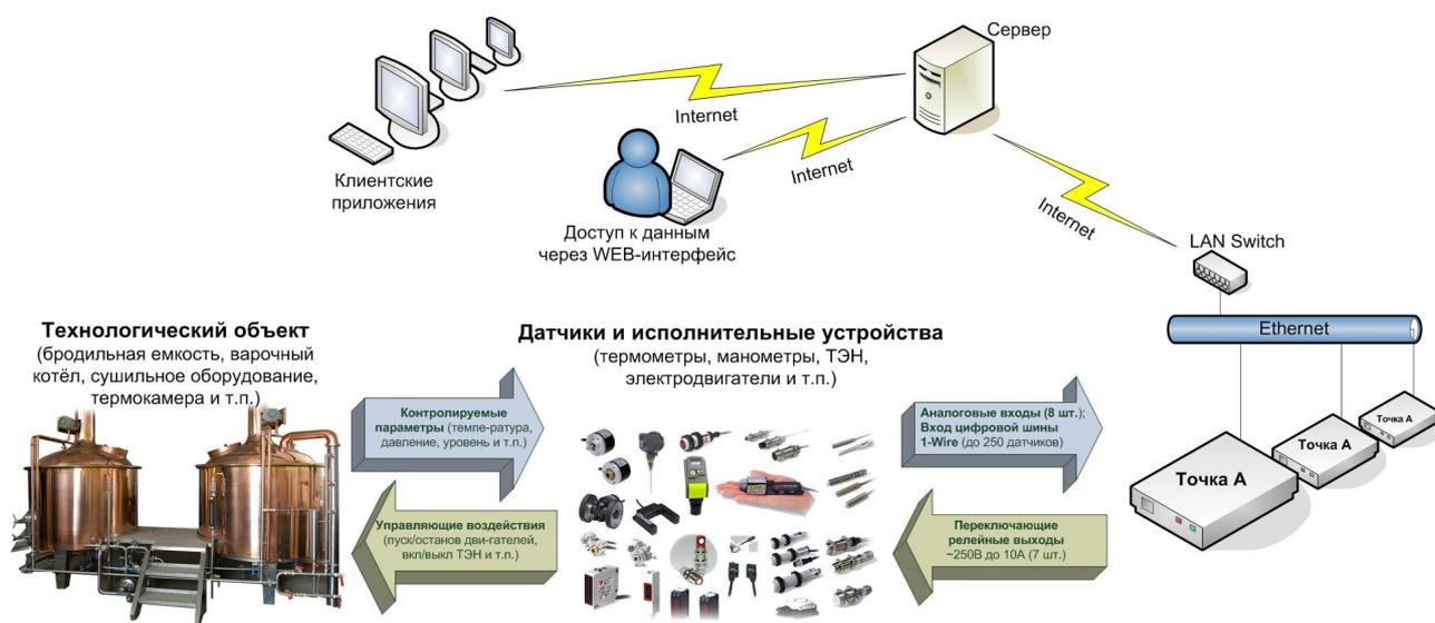
Рисунок 1 – Дистанционный контроль и управление производственным технологическим процессом.
