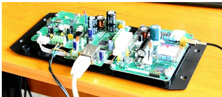
Квартирный блок со снятой верхней крышкой и квартирная панель управления (справа)
